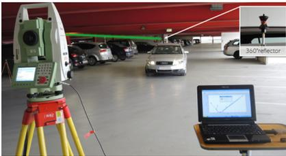
Im Rahmen des Forschungsprojektes NETI wurden von der TU Graz Ansätze zur Positionsbestimmung von Fahrzeugen in Gebäuden (Parkhäuser, Tiefgaragen) untersucht. Mittels eines geeigneten Kalman-Filters wurden absolute Positionsdaten aus Bluetooth Low Energy Location Fingerprinting mit über den CAN-Bus erhaltenen relativen Fahrzeugbewegungsdaten (Fahrzeuggeschwindigkeit, Gierrate) kombiniert. Alternativ wurde ein Partikelfilter implementiert,
